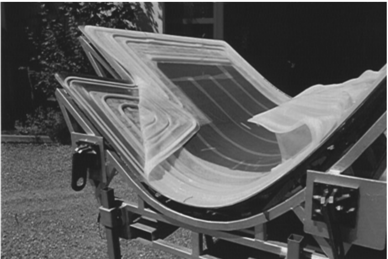
Fremdwerkzeug mit einer von uns hergestellten Silicondruckhaube
